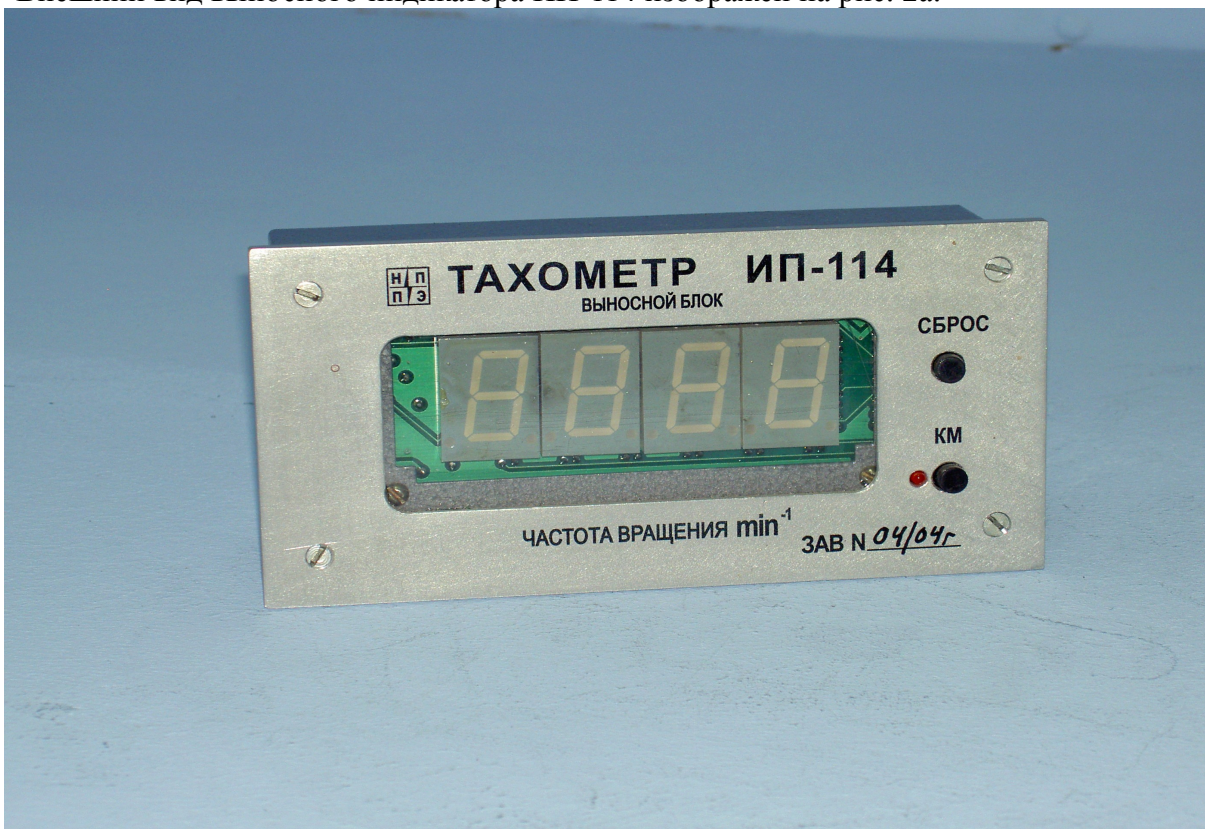
Лицевая панель выносного индикатора ИП-114.
