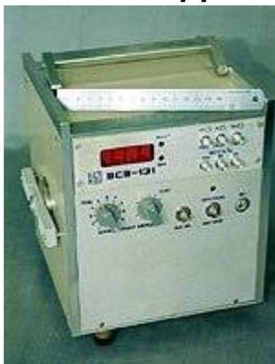
Стенд предназначен для проверки и тарировки пьезодатчиков аппаратуры "АКТИВ", приборы ИП-120, ИП-121 и аналогичных.
